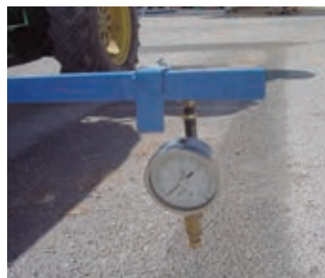
Figura 2. Medida de la presión de trabajo
