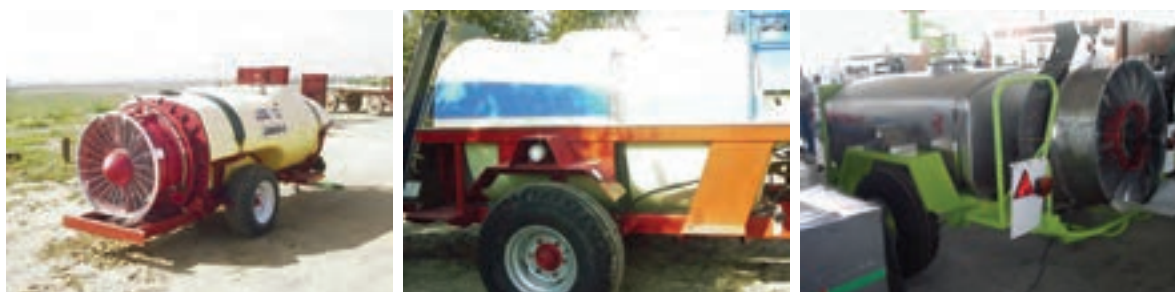
Figura 4. Depósitos para fitosanitarios. De izquierda a derecha: de polietileno, de poliéster y de acero inoxidable
