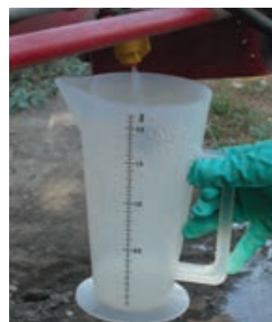
Figura 7. Medida del caudal de una boquilla
