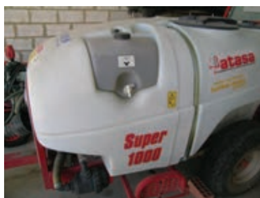
Figura 6. El depósito debe ser inspeccionado para evitar vertidos accidentales
