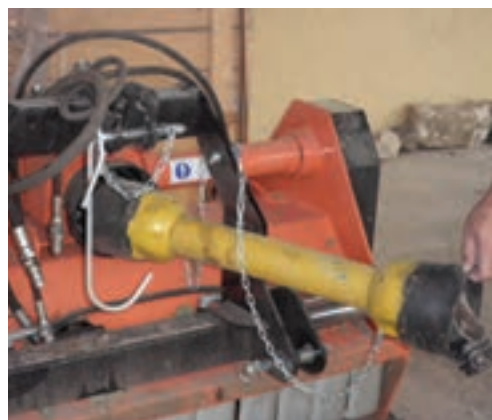
Figura 4. Toma de fuerza completamente protegida
