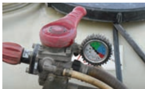
Figura 6. La presión de trabajo de la maquinaria debe ajustarse en función del tipo de boquilla
