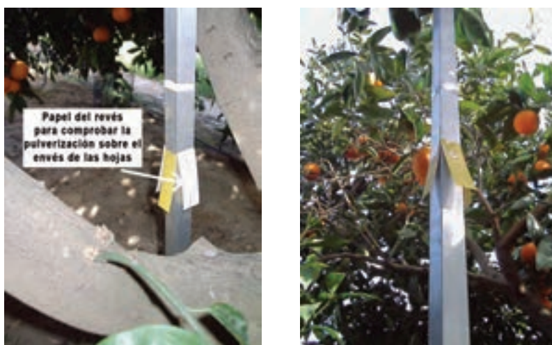
Figura 9. Papeles hidrosensibles situados a distinta altura para prueba de pulverización
