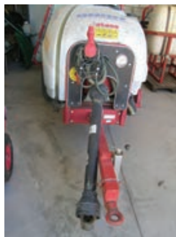
Figura 5. La toma de fuerza de la maquinaria debe estar protegida
