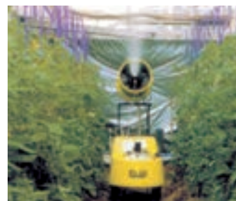
Figura 7. Nebulizador en frío, instalado en el interior de un invernadero
