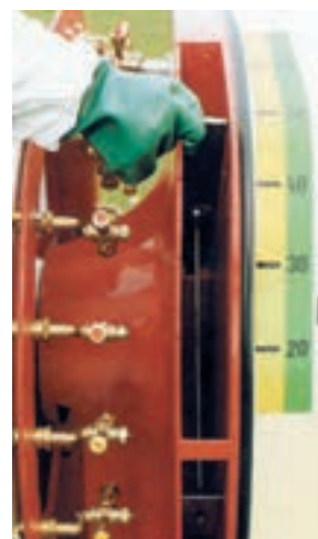
Figura 14. Barra portaboquillas en un pulverizador hidroneumático
