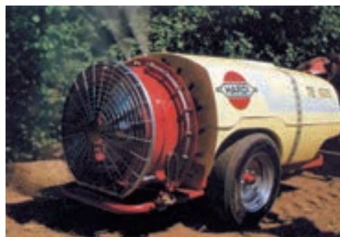
Figura 13. Pulverizador hidroneumático o atomizador
