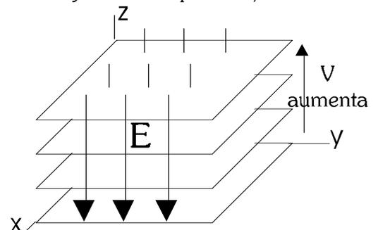
b) Un electrón, como cualquier carga eléctrica  $q$  en el interior de un campo electrostático  $\vec{E}$ , sufrirá una fuerza dada por la expresión  $\vec{F} = q \cdot \vec{E}$ . En este caso, como la carga del electrón es negativa, el sentido de la fuerza será el contrario al del campo electrostático.  $\vec{F}$  irá en el sentido positivo del eje OZ, y la
