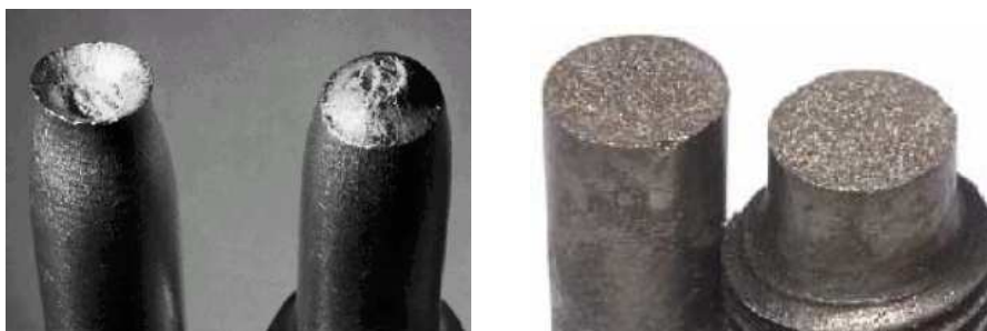
Figura A1.7 Fractura tipo copa-cono y plana
