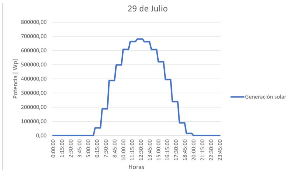
Figura 23: Generación Solar de un sistema de 1000 kWp en Sevilla. Fuente: Elaboración propia de PVGIS
