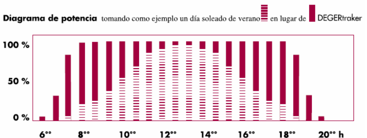
Figura 3. Diagrama de potencia que compara la potencia sobre superficie horizontal con la potencia sobre la superficie modular del seguidor en un día soleado (fuente: catálogo DEGERtraker, modelo 7000NT, del fabricante DEGERenergie).
