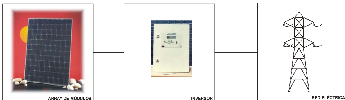
Figura 2. Esquema de una instalación fotovoltaica.
