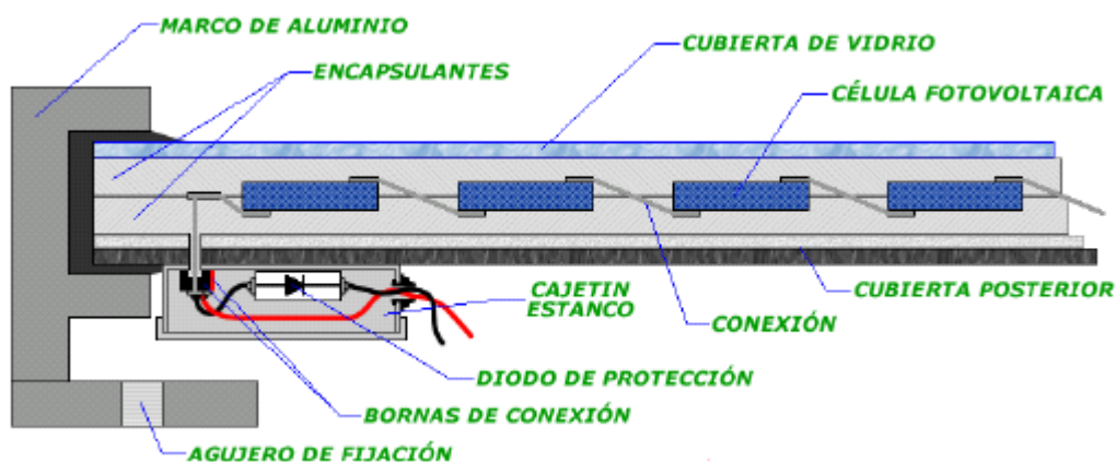
Figura 9: Elementos de un Panel Fotovoltaico.
