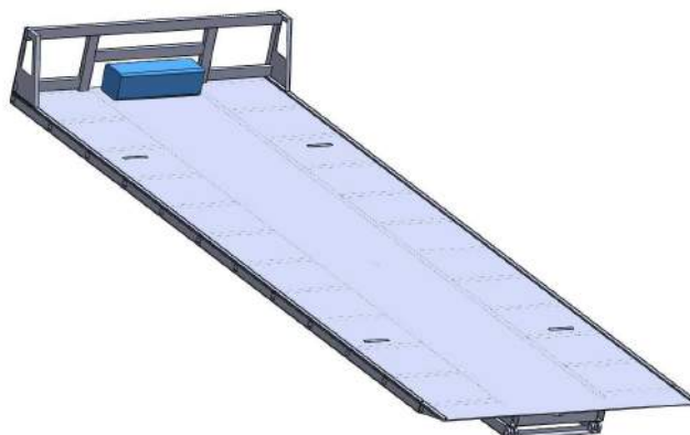
Figura 3.39 Simplificación del cabrestante para ver su ubicación en CAD
