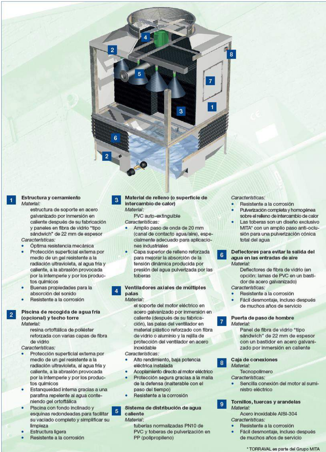
Figura 10.- Torre de enfriamiento. Componentes
