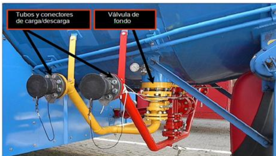
Figura 13 Tubos y conectores de carga y descarga y válvula [14]
