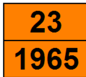
Figura 37 Panel de identificación de GLP [33]
