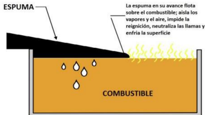
Ilustración 40. Funcionamiento de espuma en tanque
