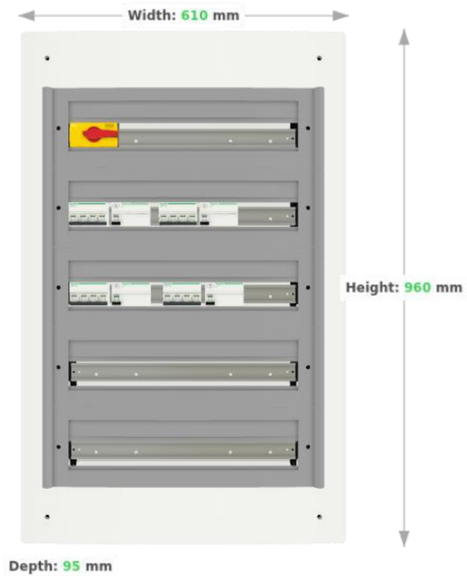
Ilustración 20 Cuadro eléctrico sin puerta
