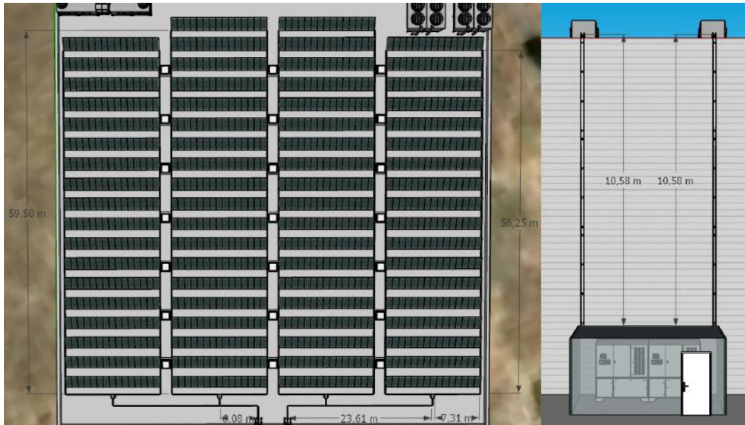
Figura F.4 Distancias en fotovoltaica en corriente continua de la instalación de 500 kWp.
