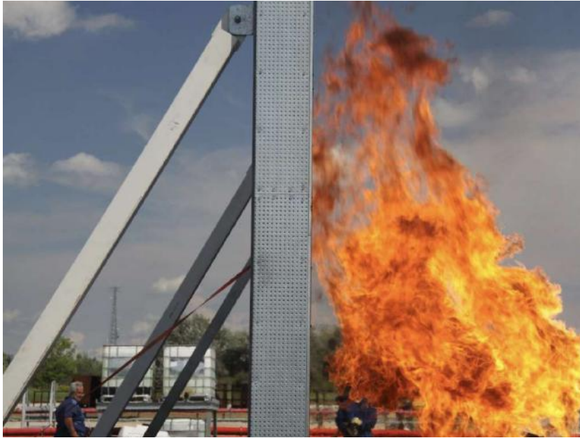
Ilustración 1.6.6.1-2 Protección muro cortafuego ante incendio
