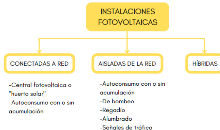
Figura 8: Tipos de instalaciones fotovoltaicas. Fuente: elaboración propia
