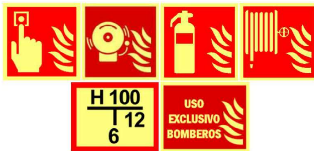
Figura 66. Ejemplos de la señalización para los equipos PCI definida en la norma UNE 23033-1 (Fuente: norma UNE 23033-1:2019)
