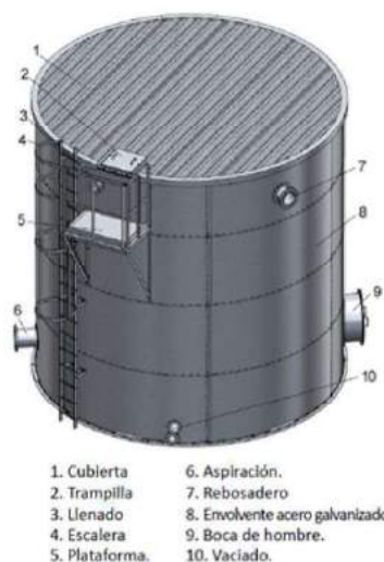
Figura 48. Tipo de depósito seleccionado para el sistema de abastecimiento (Fuente: Ficha técnica del proveedor Engineered Fire Piping)
