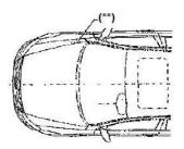
(\*) Emplazamiento de la placa del fabricante
